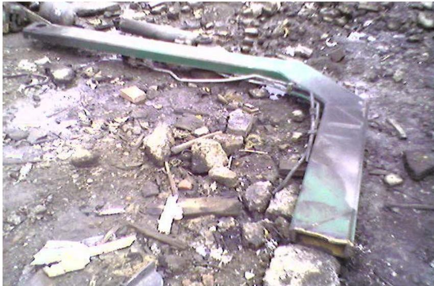
Un trabajador estaba cortando con un soplete la barra del camión de la basura que se muestra arriba. Al acercarse al final de su corte, la barra se aflojó y lo golpeó en la parte superior de la cabeza (vea el casco de la izquierda a continuación). Como se puede ver, el impacto aplastó el casco pero su cabeza se salvó. Este trabajador hoy está sano y salvo gracias al casco.
